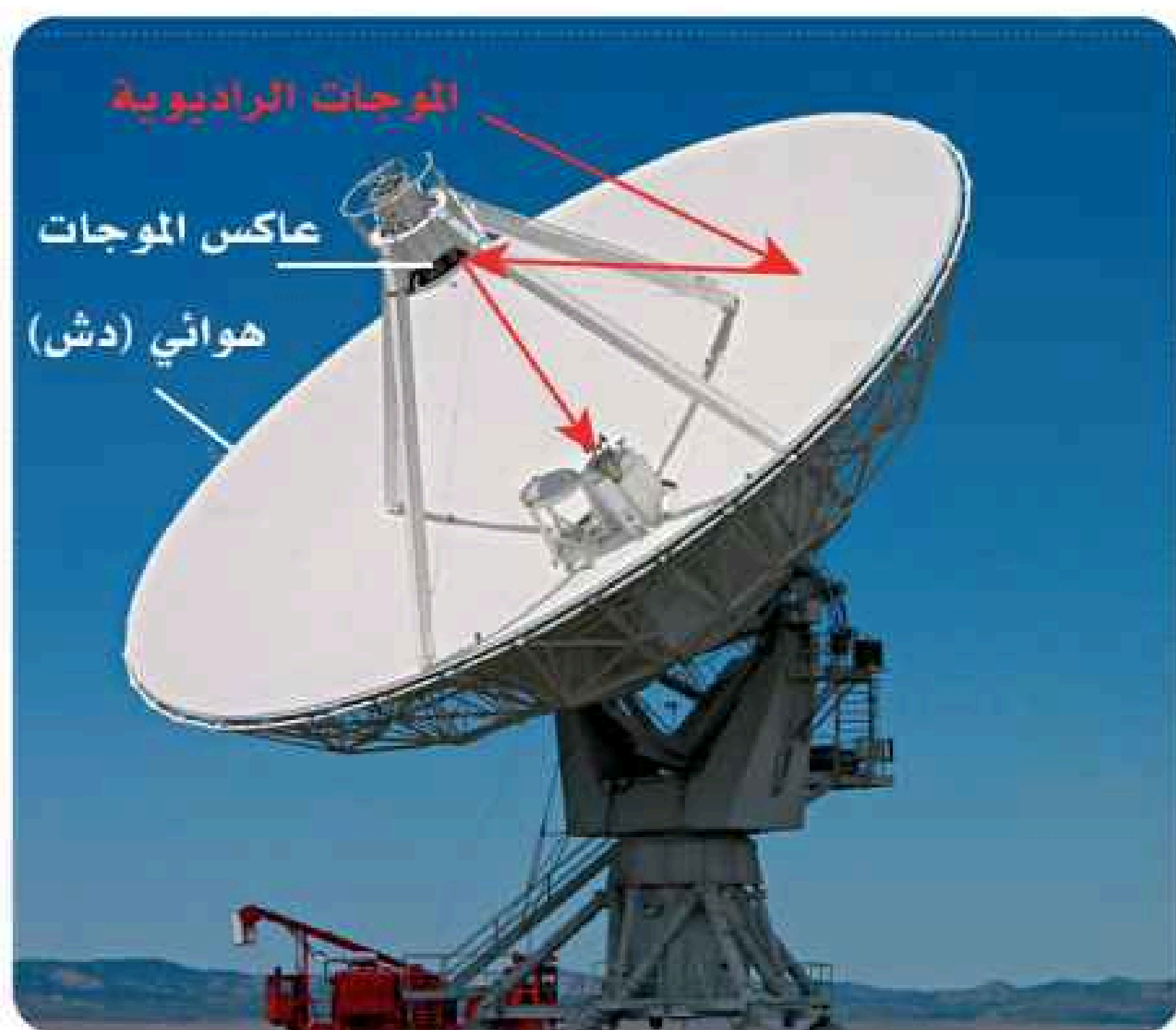
الشكل 14-3 تركيب المنظار الراديوي.
