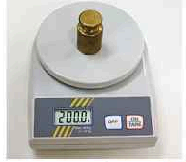
الشكل 1-11 يُختبر الضبط عن طريق قياس قيمة معلومة.
