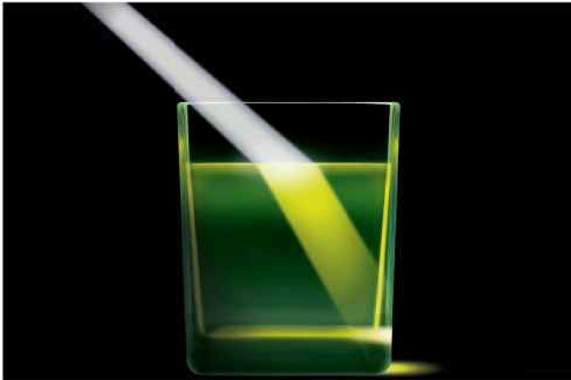
الشكل ٨ يحدث الانكسار عندما تتغير الموجة سرعتها. وقد غيرت موجات الضوء اتجاهها عندما نقصت سرعتها نتيجة انتقالها من الهواء إلى الماء.
