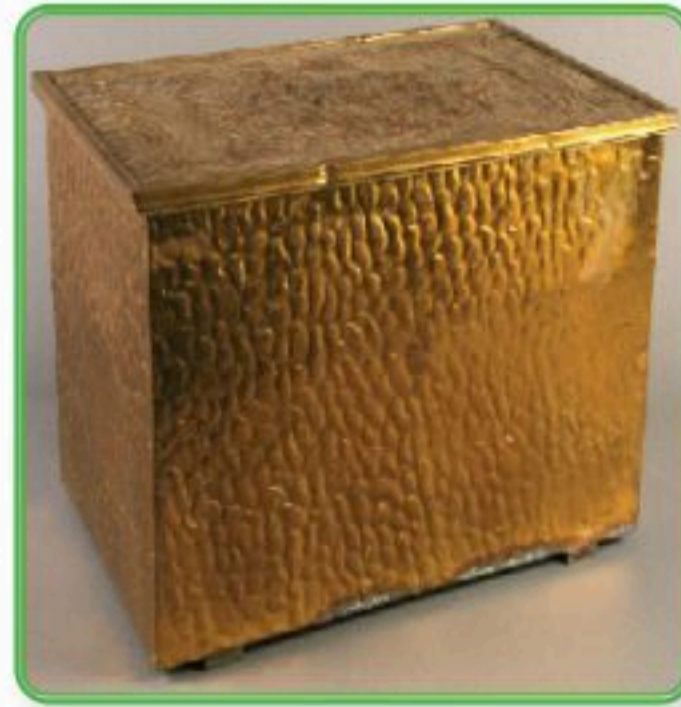
الشكل (١١٣): الطرق بالدق بالأزاميل.
