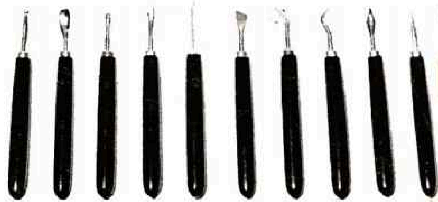
الشكل ( ١٠٨ ) : أدوات وخامات الضغط على النحاس .
