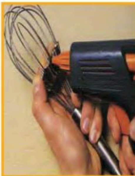
الشكل (٩٢): النوع الثاني (لحام البارد باستخدام الصمغ).
