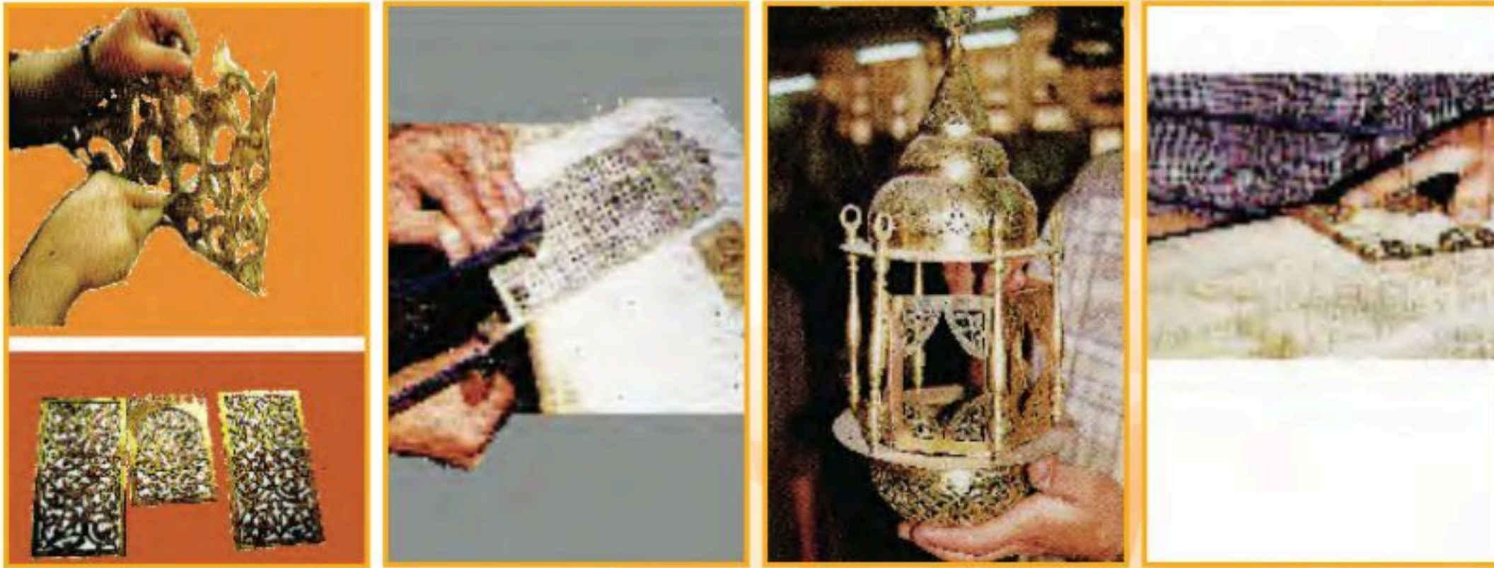
الشكل (٥٤): طرق استخدام أزاميل ومنشار المعادن
