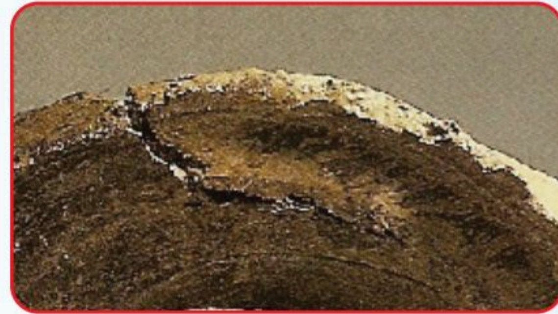
شكل (١٠٦): يوضح نتائج أخطاء التجفيف ( تشقق ).
